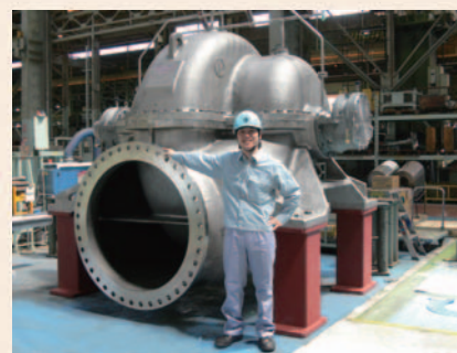
サウジアラビアの海水淡水化プラント向けポンプ(口径1100×1000mm)
