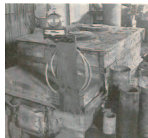
玉男の入社当時に 使用されていた浸炭炉
