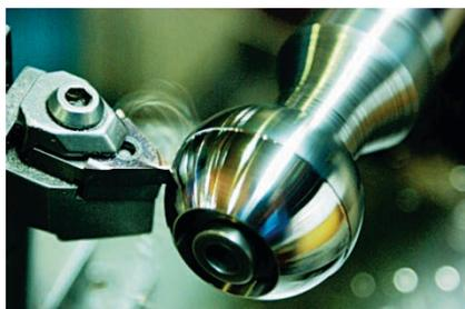
創業以来50年以上にわたりバルブボールの製造を行う同社。主要バルブメーカーに高品質な製品を提供し続け、ステンレス製バルブボールでは国内60%のトップシェアを誇ります。同社における生産全体のおよそ30%は特殊な耐摩耗バルブボールで、この球体形状には、真球精度0.1～0.3 $\mu$ mで加工する真球加工技術(切削)と、表面を滑らかに磨く研磨加工技術(研磨)が必要となります。この球体加工技術こそが他社を寄せつけない固有の強みです。海外メーカーでは難しく、国内企業であっても、この両方を高精度で実現できる企業は非常にわずかとされています。そのため、石油プラントや水力発電所、火力発電所などの納入実績が多数あり、大手バルブメーカーから高い信頼を得ています。
