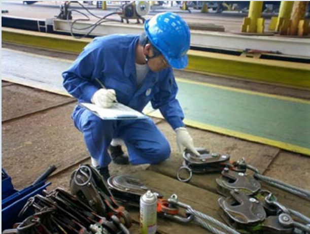
クランプの点検作業中の様子
