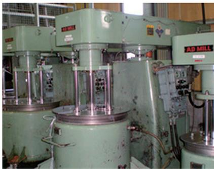
塗料の分散・攪拌工程
