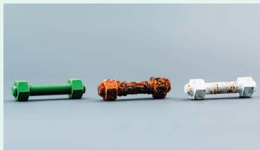
他社製品との比較(塩水噴霧試験 3000 時間後) 左がタケコート®-1000
