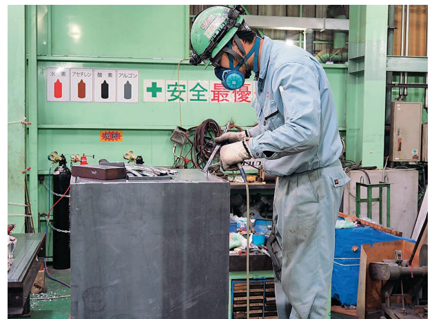
若手社員が行う鉛溶着作業の様子 若手の技術力が当社の自慢です
