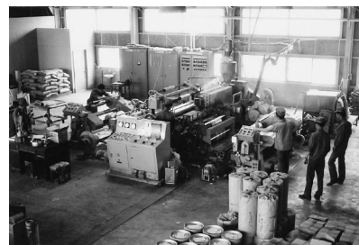
昔の押出ラミネート工場風景 ラミネートとは、複数の素材を貼り合わせることを表す。高温で溶かした樹脂をフィルム状に押し出し、ほかの素材と接着剤なしで圧着する。
