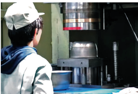
性質の異なる数種類の素材が積層された構造の板材。これを深絞り加工するのはきわめて難しい。
