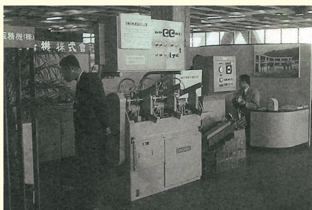
第2回日本国際工作機械見本市出展 SF - 3型機(試作機)軸受内輪内径自動選別機
