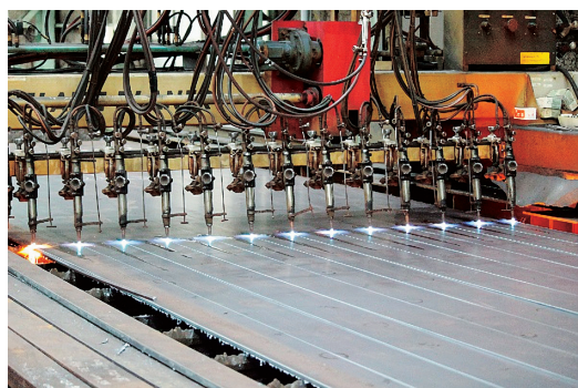
プレーナーでは最大の3m×40m×100mmの大きさの厚板を溶断できる
