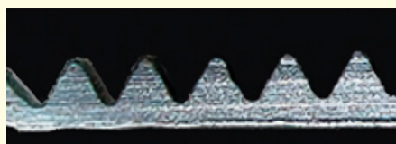
切削ねじの断面
