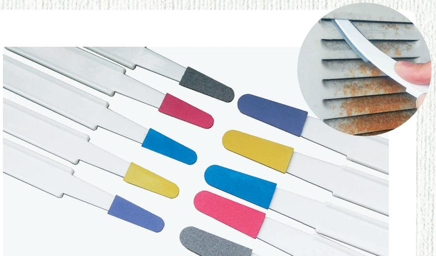
厚で、幅 15mm(大)と幅 10mm(小)の2種類のサイズがあり、砥粒の粗目から細目を色分けして一般のお客様にもわかりやすくしています。工業関係では金型修正、焼け取り、薄サビ取り、趣味関係ではプラモデル、模型細工などの研磨に使用されています。最近では、シンク周りの汚れを落とす掃除用具としても使用されており、ゴム臭さをなくすためバニラの香りを配合し、一般家庭でも使いやすい仕様にしました。現在は、全国のホームセンターやホビーショップに陳列されています。
